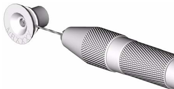
Рис. 1. Прочистка отверстий для компонента А (изоцианат)
